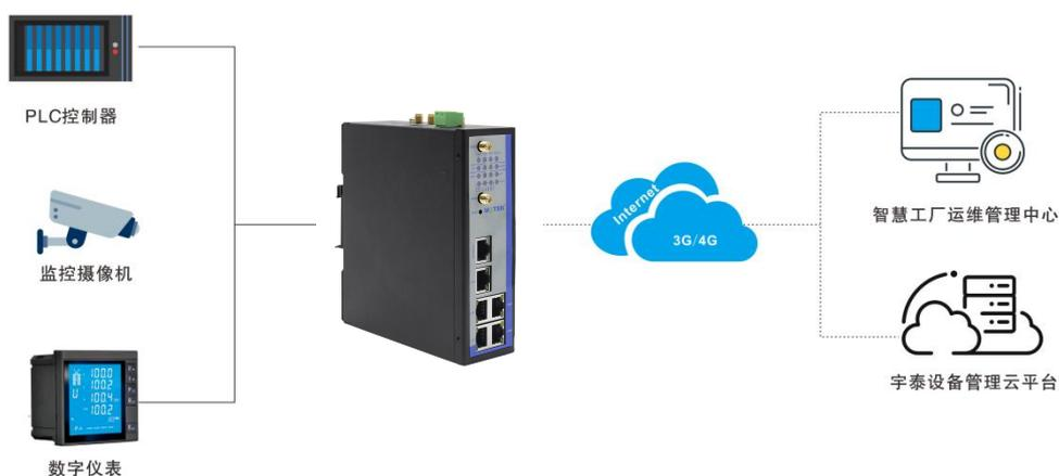
R9960系列工业路由器产品，支持移动蜂窝，Wi-Fi，有线网络等接入方式。通过设备管理云平台进行远程配置和管理，可视化、远程运维管理系统解决方案，广泛应用于智慧电力、智慧农业、智能交通、智慧医疗、智慧工厂、智慧水利、智慧环保、智慧城市、工业控制等领域。
