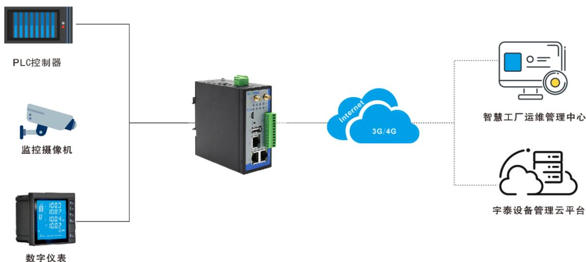
G9805系列4G工业网关，可实现工业生产现场的PLC、HMI、工业高清摄像头与网关连接，通过网关进行数据采集、数据预处理、数据分析。并通过MQTT、HTTP协议并上报到云端系统。云平台可实现设备远程状态监控，故障诊断分析、实时告警，实现可视化、帮助中小企业实现一套工业智能远程运维管理系统解决方案。
